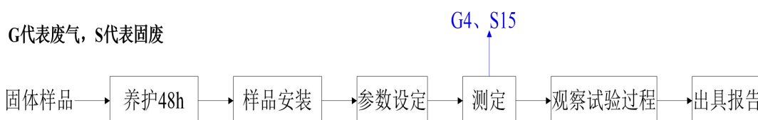
图 2.3-15 建筑材料或制品的阻燃实验流程图
